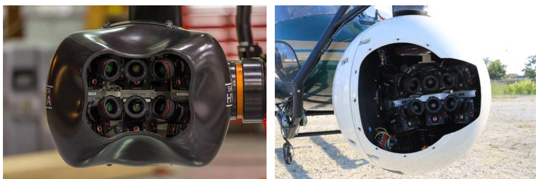
图 3-1 两种用于球幕拍摄的相机阵列 Shot over Hydra 和 Pictor Vision Eclipse
