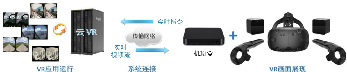
图 32 天途云 VR 端到端技术架构
