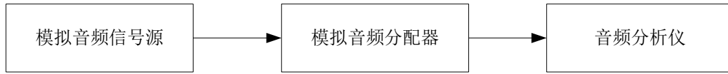
图6 介入增益、信噪比（不加权）、幅频特性、总谐波失真加噪声、通道间串音、通道间电平差、通道间相位差测量框图
